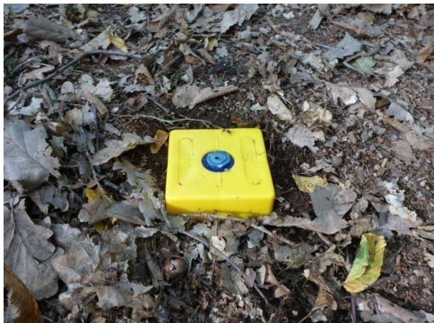
Roh DP fixovaný geodetickým mezníkem
