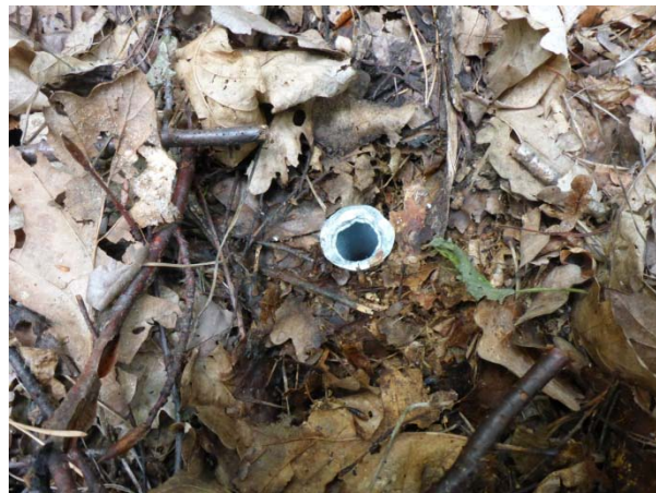
Fotobod fixovaný ocelovou trubkou
