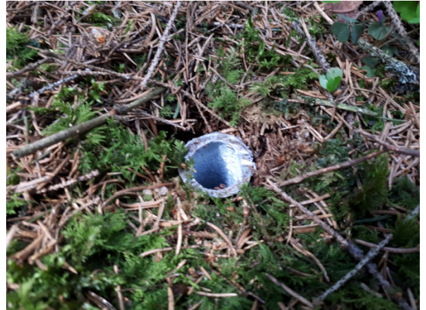
Fotobod fixovaný ocelovou trubkou
