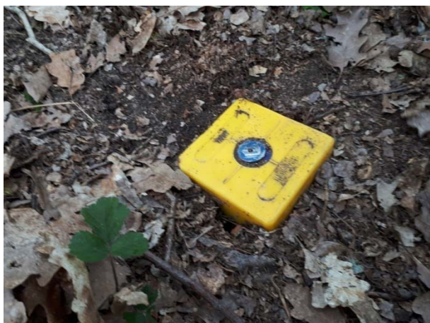
Roh DP fixovaný geodetickým mezníkem
