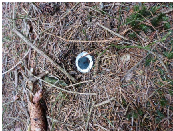
Fotobod fixovaný ocelovou trubkou
