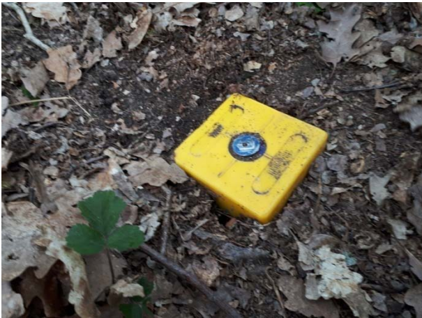
Roh DP fixovaný geodetickým mezníkem
