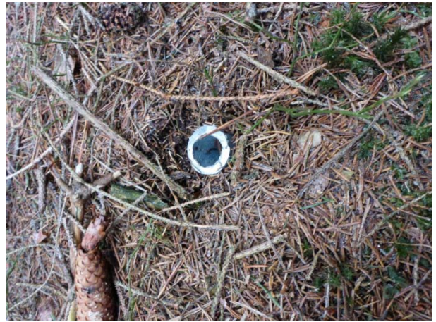
Fotobod fixovaný ocelovou trubkou
