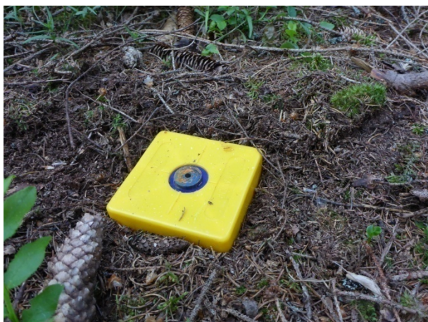
Roh DP fixovaný geodetickým mezníkem
