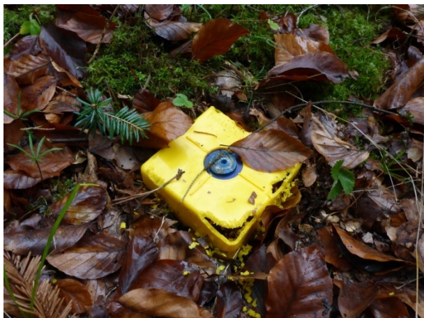
Roh DP fixovaný geodetickým mezníkem
